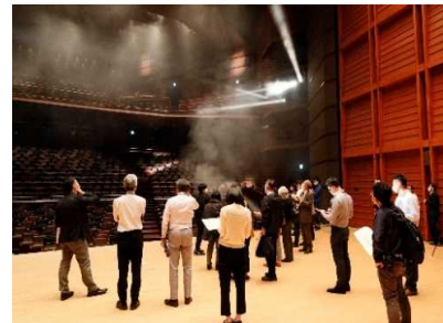
大ホール換気検証実験
